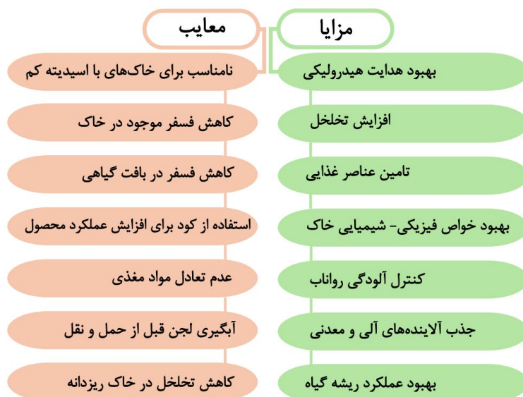
شکل ۲: مزایا و معایب بالقوه استفاده از لجن در زمین [۳۷].
