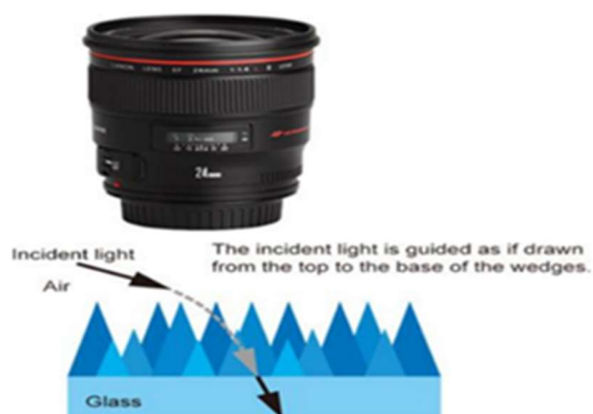
شکل ۱۵: پوشش SWC ضد بازتاب لنز دوربین‌های Canon الهام‌گرفته از چشم شب‌پره‌ها
