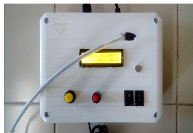
شکل ۵: این تسلامتر توسط یکی از دانشجویان آزمایشگاه بیوشیمی فیزیک در مرکز تحقیقات بیوشیمی و بیوفیزیک دانشگاه تهران ساخته شده است.
